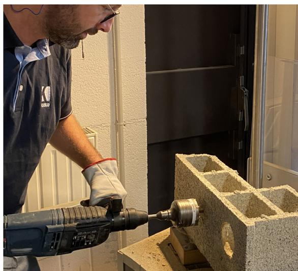
**Emmanchement SDS PLUS** : idéalement puissance de la machine supérieure à 800W
